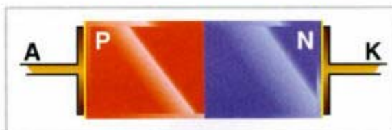
Il diodo è formato da un pezzo di semiconduttore con una zona N e un'altra P, due terminali di collegamento e una capsula che lo protegge.
