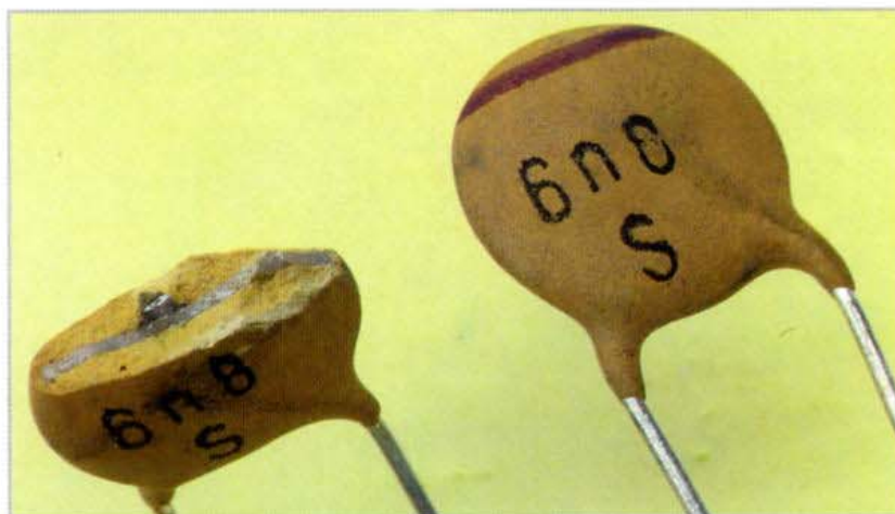
I condensatori ceramici consistono in un pezzo di ceramica metallizzata su entrambe le facce.
