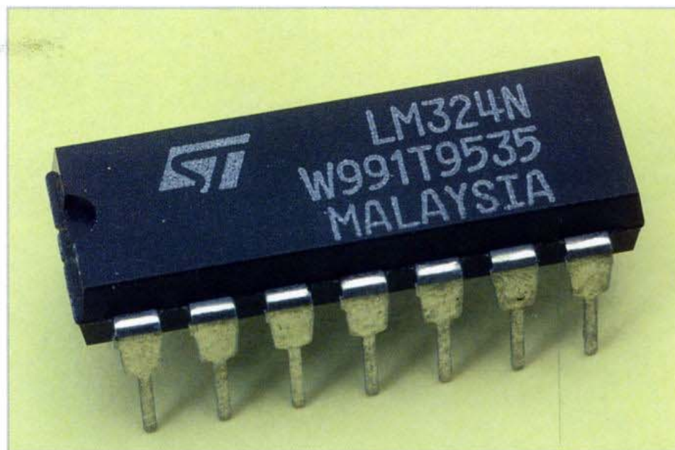
Il circuito integrato 324 contiene quattro amplificatori operazionali nel suo interno e si può utilizzare con alimentazione asimmetrica.
