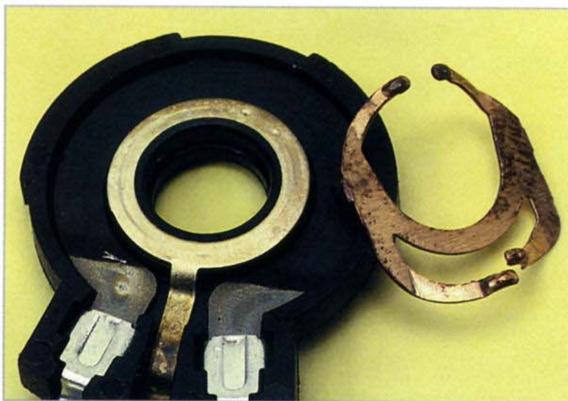
La resistenza e il cursore che vi scorre sopra, collegato al terminale centrale, sono i principali componenti del potenziometro.
