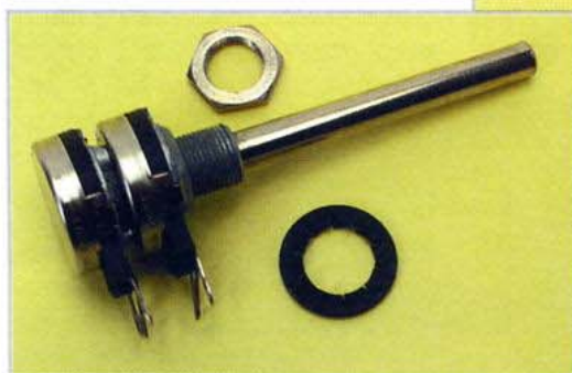
Potenzimetro doppio. In realtà si tratta di due potenziometri i cui cursori vengono azionati simultaneamente.
