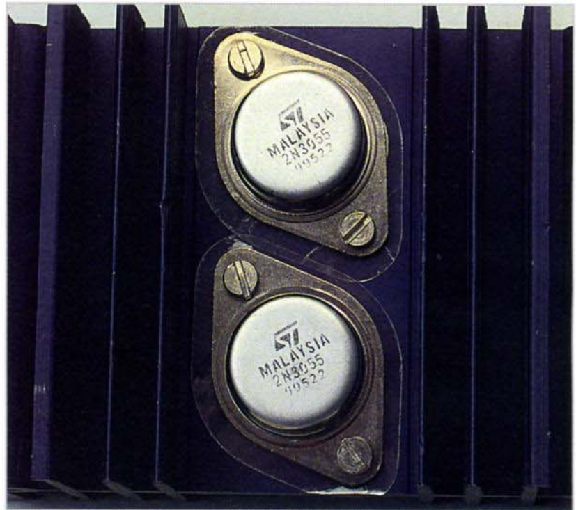
L'inserimento dei radiatori facilita la dissipazione del calore.
