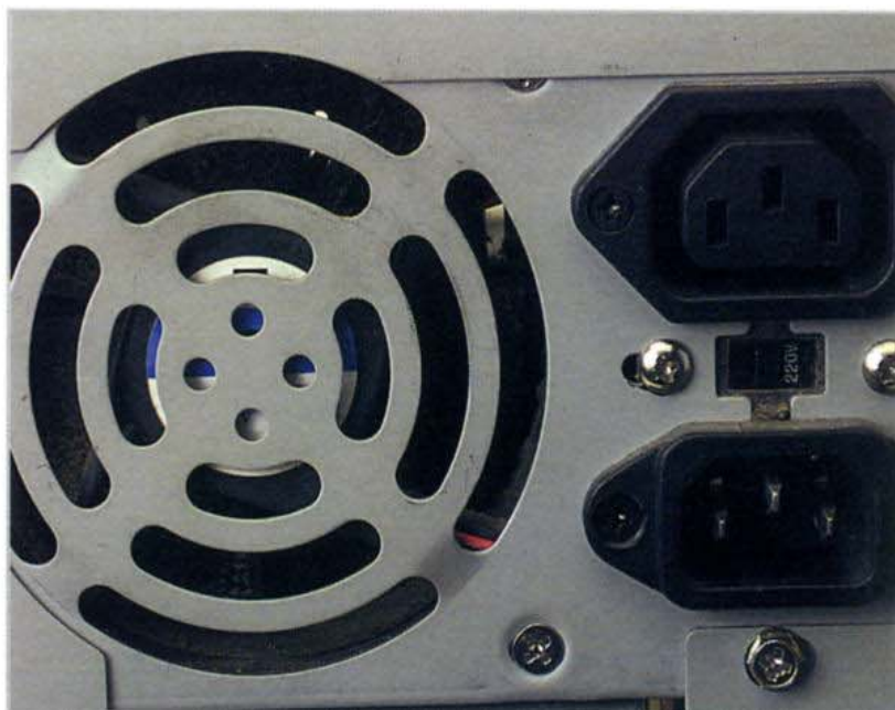
Molte apparecchiature dispongono di ventilatori al fine di forzare l'uscita dell'aria calda all'esterno.
