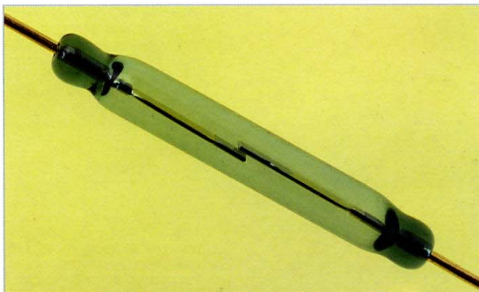
Dettaglio dell'ampolla con contatti di un relé reed.
