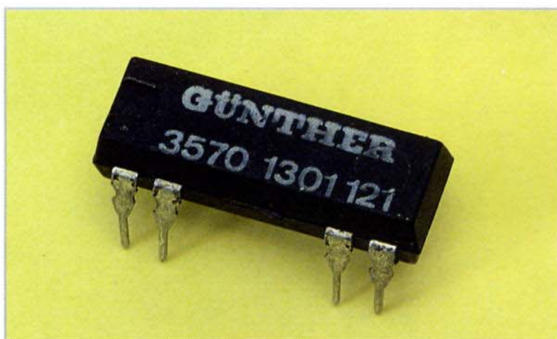
Relé con distribuzione dei terminali che permette il suo utilizzo negli zoccoli dei circuiti integrati.
