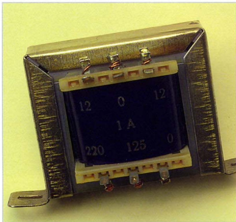
Trasformatore con presa intermedia collocata nel secondario per ottenere 12, 0, 12 Volt.
