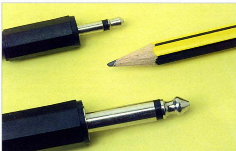
I connettori del tipo jack possono avere diversi diametri, i più usati sono quelli da 3,5 mm di diametro.
