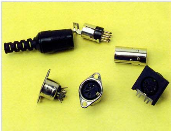
Connettori DIN: si usano nel settore audio e nelle connessioni delle tastiere dei computer.
