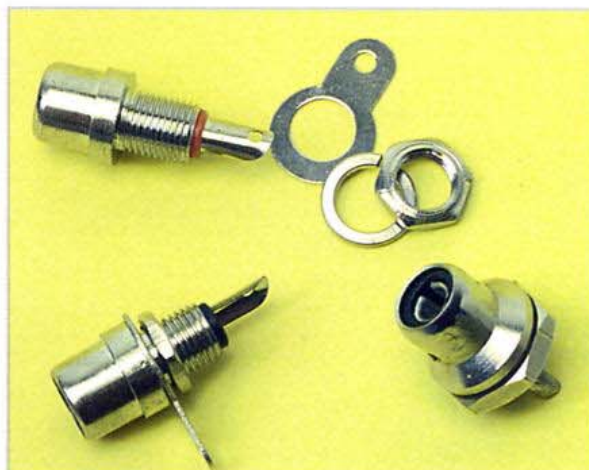
Connettori RCA da pannello, usati sugli impianti HI-FI.
