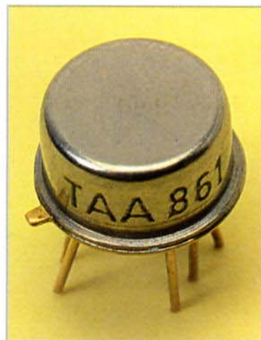
Circuito integrato con capsula metallica.
