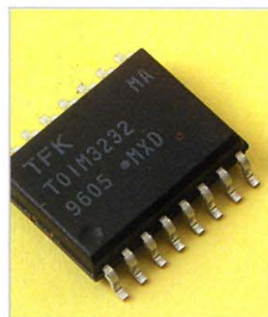
Anche i circuiti integrati si costruiscono con i terminali per SMD.
