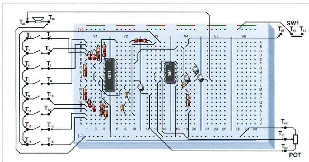
Il circuito è un piccolo organo elettronico, forse il più semplice che sia possibile costruire, con tutta la scala di note della 5ª ottava, di cui mostriamo nella tavola le frequenze. Ogni pulsante corrisponde a una delle note musicali della scala che potremo ascoltare attraverso l'altoparlante. Il volume del suono può essere regolato con il potenziometro del pannello frontale del laboratorio.
