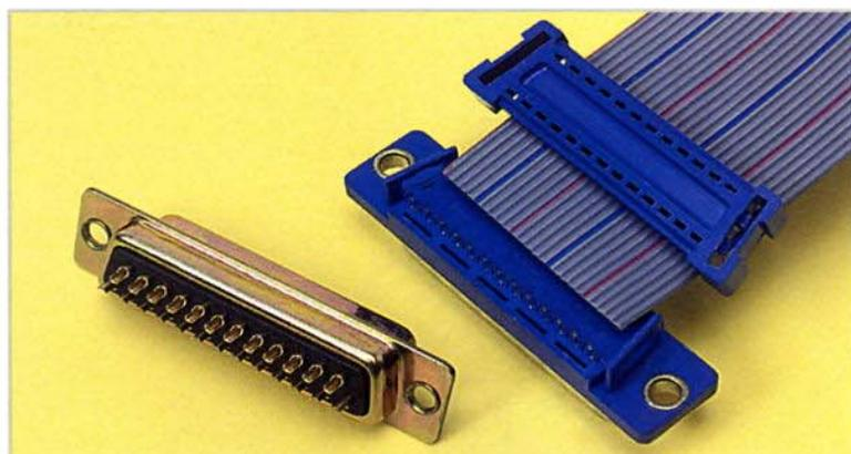
I connettori più utilizzati nelle applicazioni commerciali hanno i terminali saldati o sono pinzati in un cavo piatto, quest'ultima versione ha una protezione isolante.
