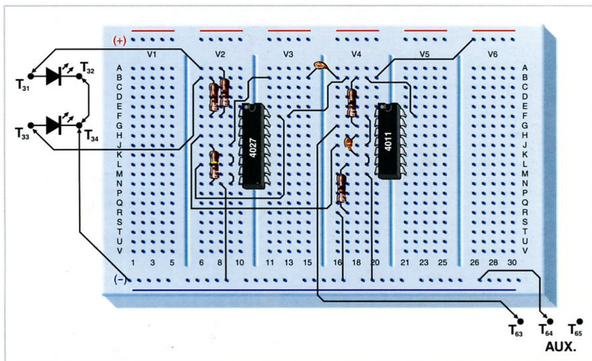
Un interruttore è un dispositivo meccanico, che apre o chiude dei contatti metallici, che col tempo tendono a deteriorarsi. In questo caso, si sostituisce la meccanica con l'elettronica e si riesce ad ottenere un interruttore senza contatti che possano rompersi e che inoltre si attiva grazie al tocco. L'uscita cambia da attiva a inattiva ogni volta che si preme sui terminali che agiscono da sensore.
