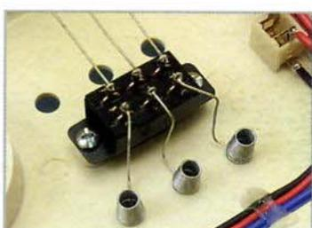
**7** Si dispone solamente di un circuito commutato. I cavi corrispondenti all'altro circuito rimangono, al momento, senza connessione.
