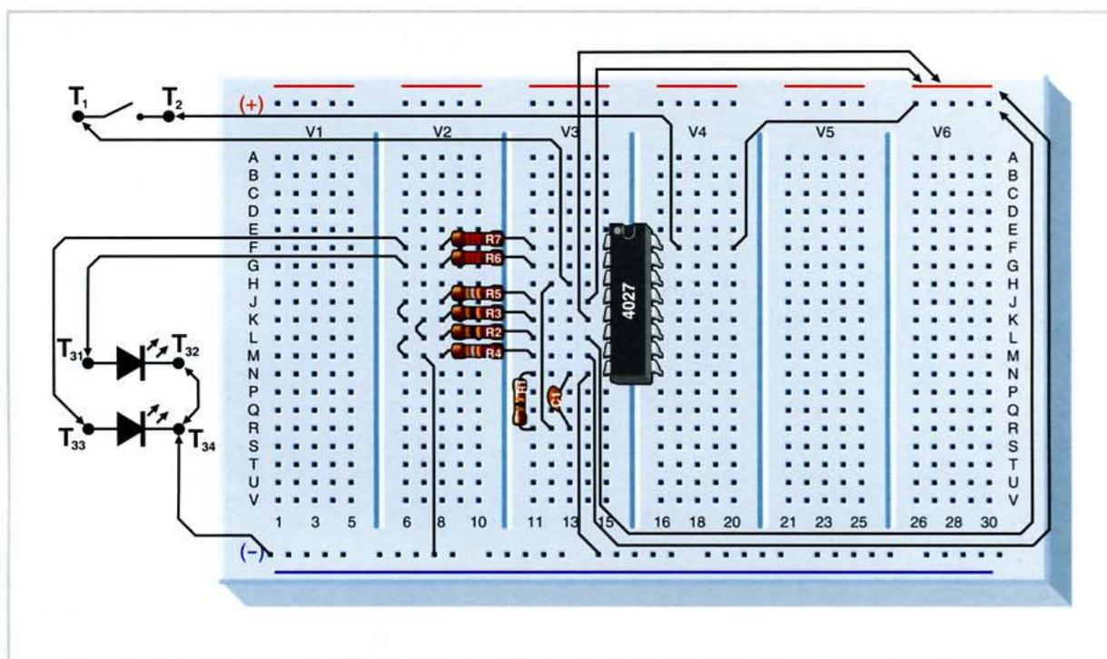
Questo montaggio viene utilizzato per verificare i due flip-flop JK che l'integrato 4027 possiede; possiamo, inoltre, generalizzarne l'utilizzo per verificare anche qualsiasi flip-flop di questo tipo. Il fatto di poter verificare i flip-flop è importantissimo, perché ci rende sicuri che i nostri montaggi non si guasteranno, sempre che siano in buono stato.
