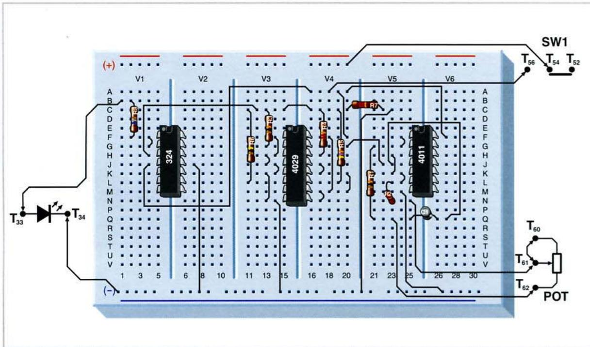
Il circuito genera una tensione a rampa, che varierà automaticamente la luminosità del LED. La rapidità con cui il LED raggiunge la massima illuminazione può essere direttamente controllata mediante il potenziometro dell'oscillatore, che è quello che provoca a ogni impulso l'incremento della tensione all'uscita del circuito.
