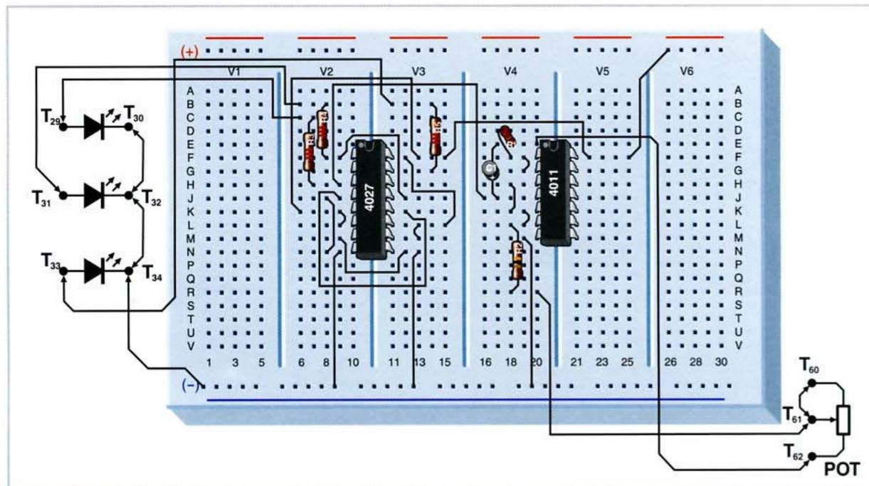
Con questo circuito, in cui i flip-flop JK del circuito integrato 4027 vengono configurati come flip-flop T, si parte da una frequenza del clock raggiunta a partire dall'oscillatore astabile formato con le porte NAND, dividendo per due e per quattro la frequenza del suddetto oscillatore. Possiamo verificare visualmente questa divisione osservando la cadenza d'accensione di ogni LED.
