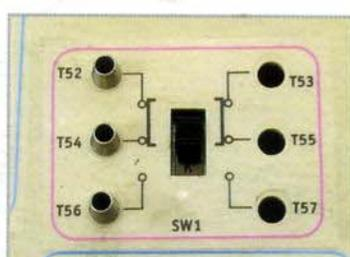
**8** Il commutatore viene azionato dall'esterno, ruotando il comando verso la zona in cui c'è il terminale corrispondente al circuito da collegare.
