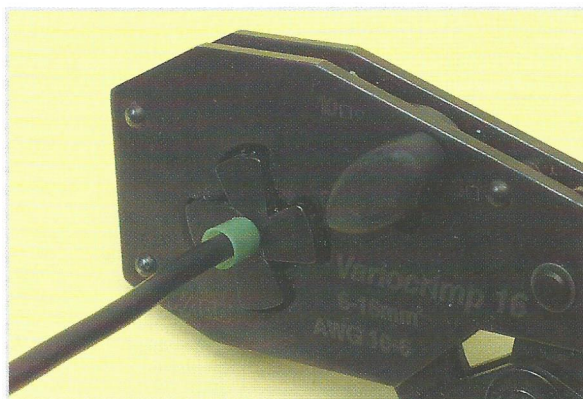
Ogni terminale deve essere chiuso con la pinza adeguata.
