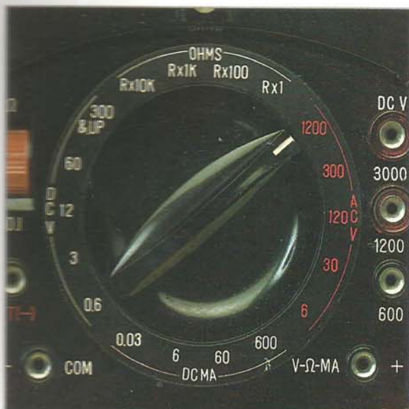
Selettore di scala e misura di un multimetro analogico.
