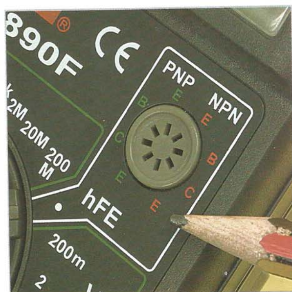
Zoccoli per la verifica dei transistor.
