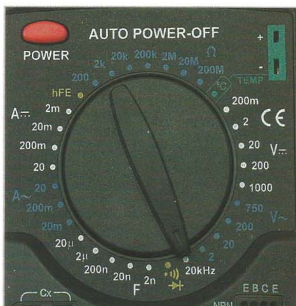
Selettore di scala e misura di un multimetro digitale.
