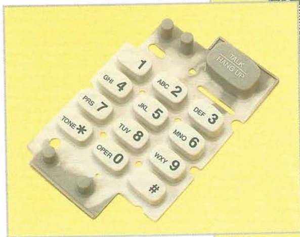
Tastiera di silicone vista dal lato dal quale viene utilizzata.
