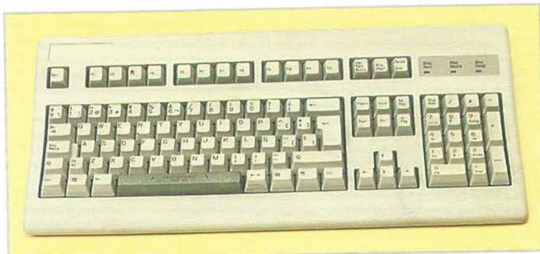
Tastiera di computer: oltre alle zone di contatto dei tasti, è dotata di elementi di elettronica di controllo per l'invio delle informazioni al computer tramite un ridottissimo numero di fili.
