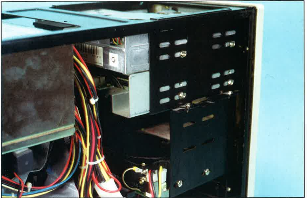
Il disco rigido e i disk drive sono situati sulla parte anteriore del PC, dietro alla mascherina frontale
