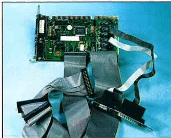
Scheda multifunzione che gestisce le porte di comunicazione, i dischi flessibili, e i dischi rigidi con bus IDE
