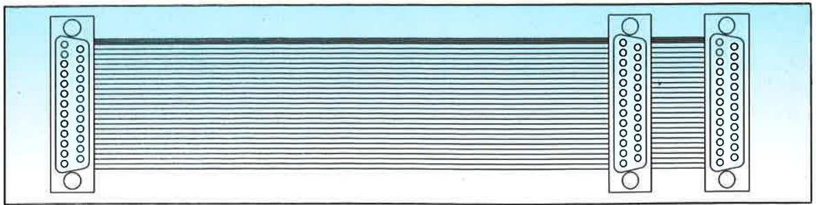
L'impiego di un flat cable rende più semplice la costruzione del cavo di collegamento
