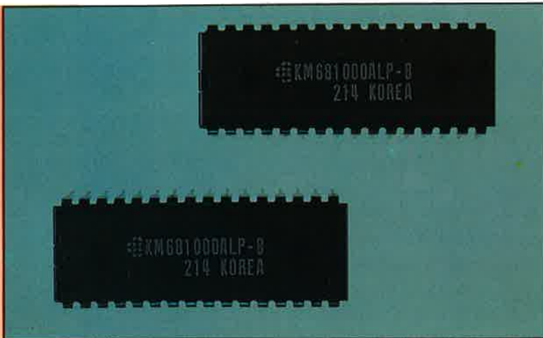
Circuiti integrati con capacità di 1 Mbit
