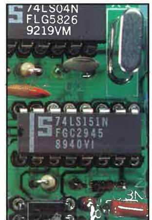
*Con il commutatore degli ingressi viene completato il circuito del frequenzimetro digitale*
