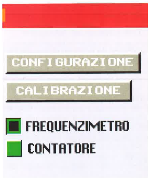
I tasti di selezione permettono l'impostazione della modalità di funzionamento dello strumento
