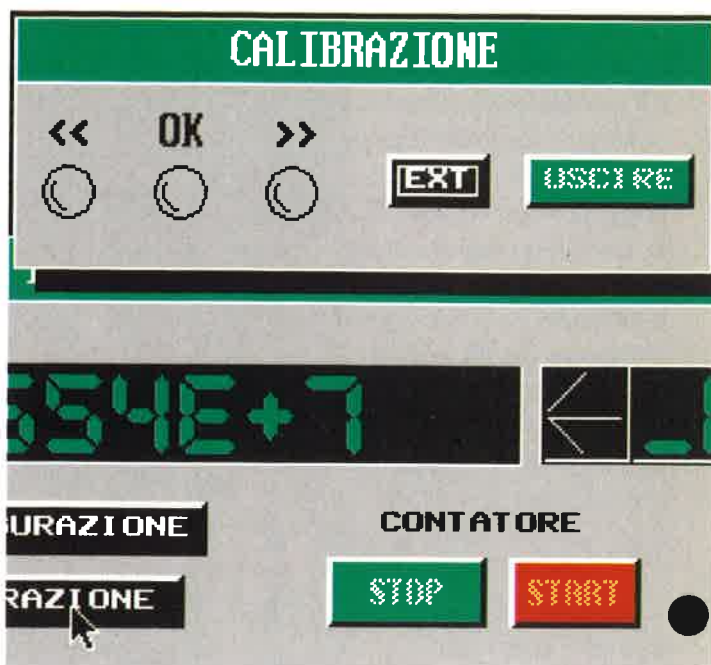
Il pannello di calibrazione del programma CONTATORE permette di effettuare la regolazione solo con un segnale di 5 MHz applicato all'ingresso TTL
