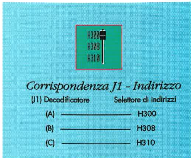
Schema indicativo degli indirizzi gestiti dal programma, e corrispondente posizione del jumper sulla scheda di decodifica
