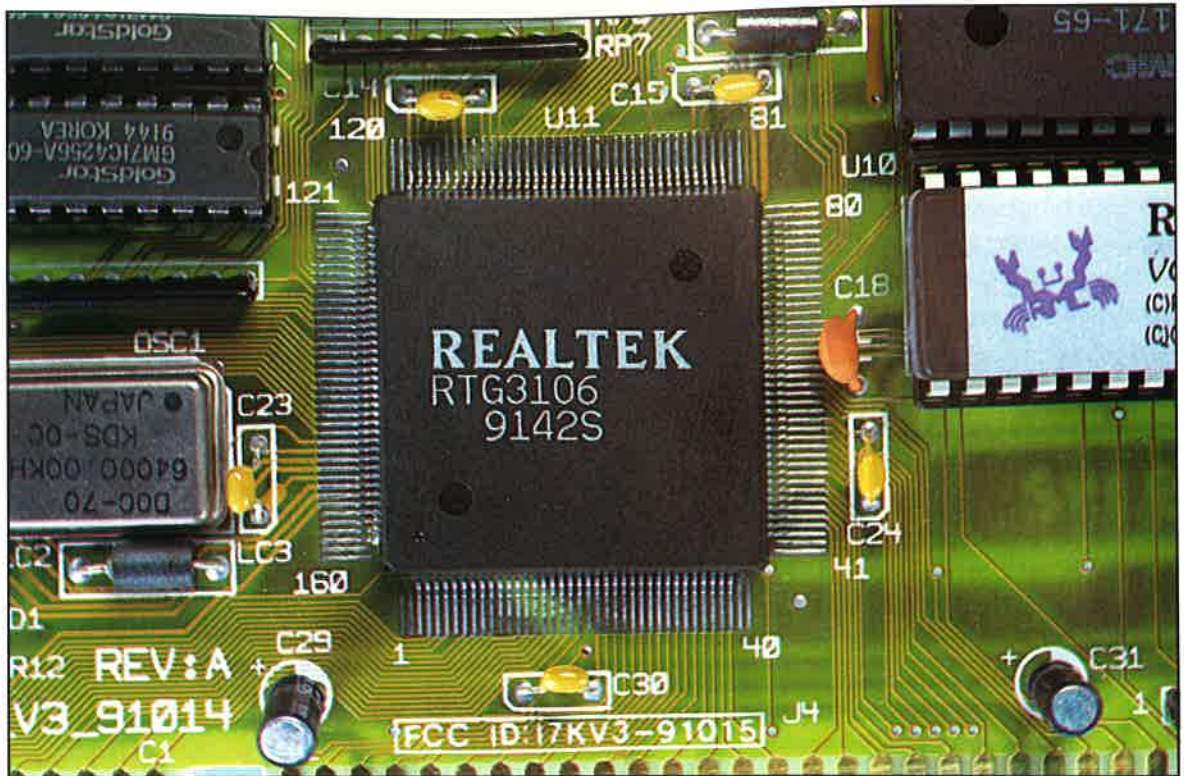
Il circuito di controllo gestisce le diverse parti della scheda VGA ed elabora i segnali di sincronismo orizzontale e verticale
