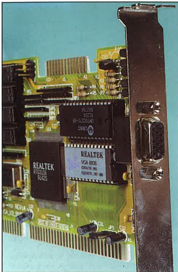
Il connettore Sub-D a 15 terminali serve per il collegamento tra la scheda e il monitor
