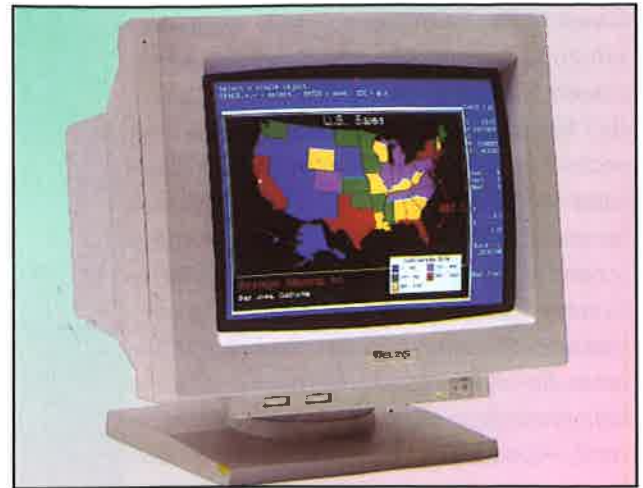
Lo standard SVGA con risoluzione 1024x768 e dimensione del pixel di 0,28 mm è uno strumento indispensabile per applicazioni professionali
