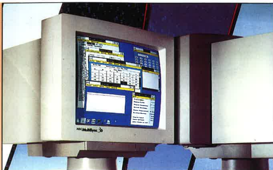
Il vantaggio che presenta un monitor multisync è quello di adattarsi a qualsiasi scheda grafica
