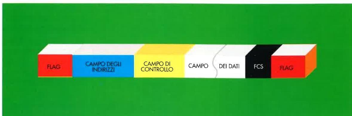
Struttura convenzionale di una catena di dati, nella quale si possono osservare i vari campi che la compongono
