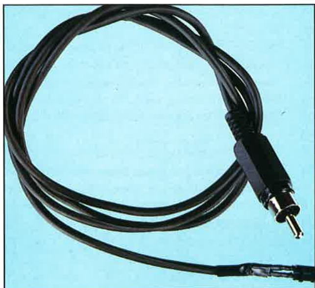
Cavo di collegamento tra il dispositivo radio e l'interfaccia. In questo caso, ad un capo del cavo è stata montata una presa RCA
