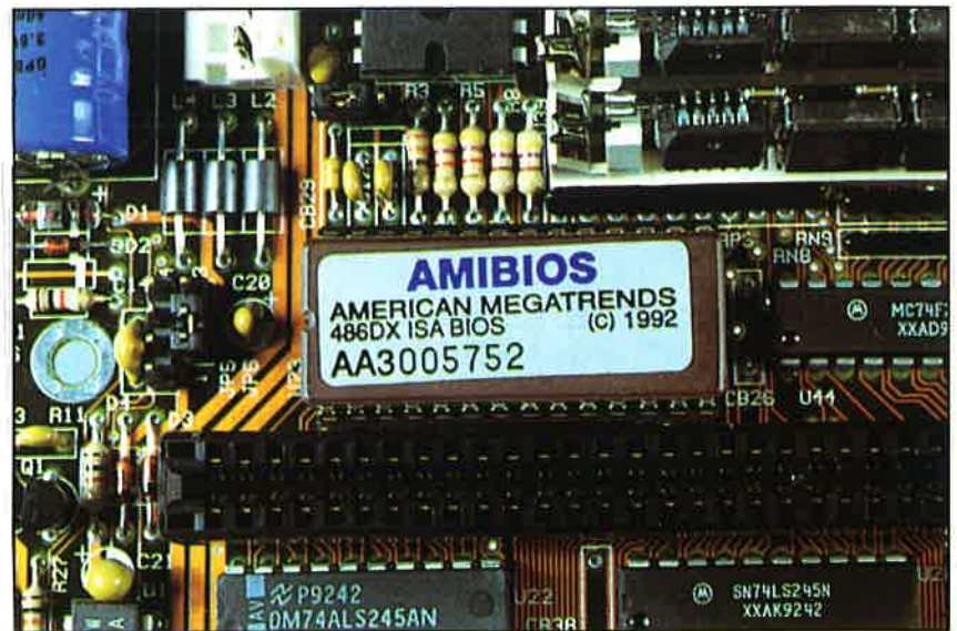
Dettaglio della ROM-BIOS di una scheda madre del PC386
