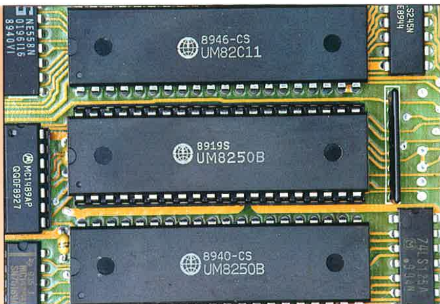
L'8250 è l'UART più comunemente utilizzato nelle schede per la comunicazione tra il PC e le periferiche
