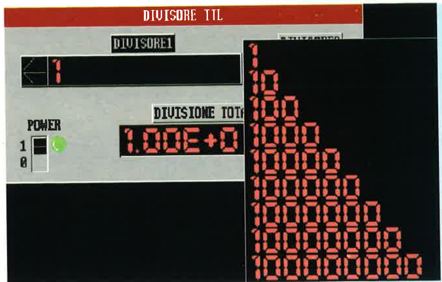
La selezione del fattore di divisione per 10 si realizza tramite i quattro bit meno significativi del registro. Tramite l'indicatore DIVISORE1 si può selezionare il fattore di divisione per 10.
