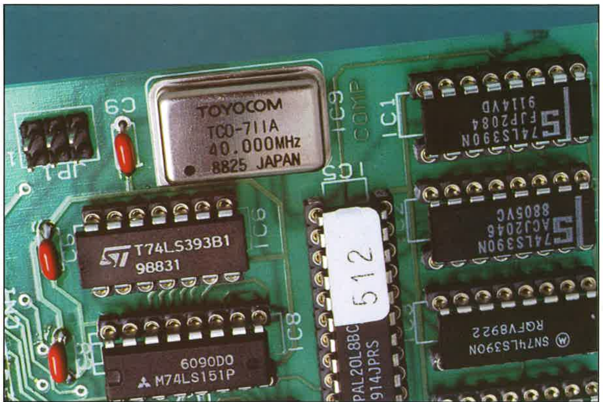
Funzionando come generatore il circuito utilizza un segnale di clock per il riferimento di frequenza
