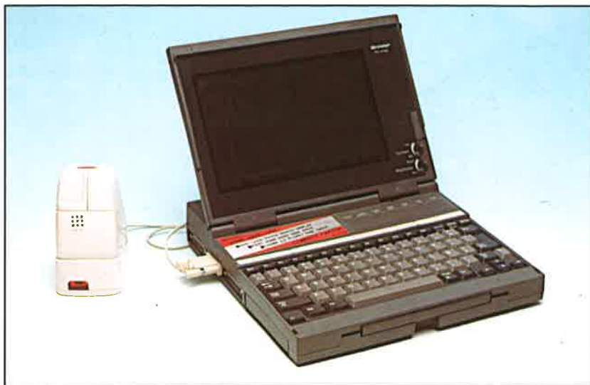
La porta di comunicazione seriale RS232 è quella utilizzata per il connettore del mouse
