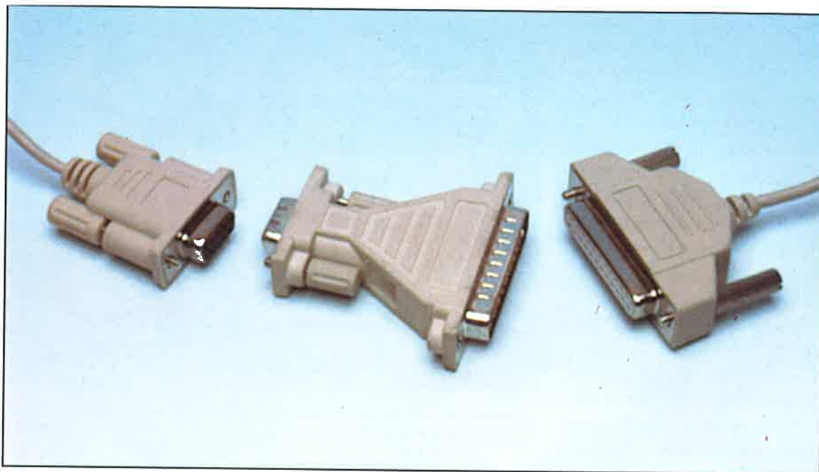
La conversione da 9 a 25 terminali e viceversa è molto utile per adattare qualsiasi tipo di mouse a un determinato tipo di PC
