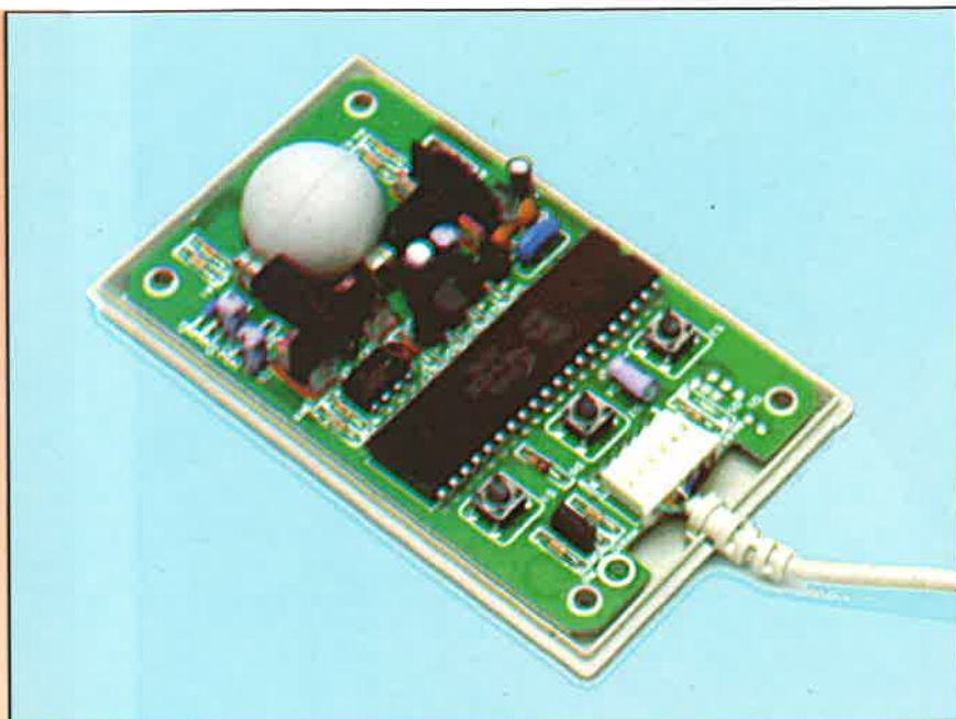
I movimenti della sfera sono trasmessi all'hardware del mouse, per essere inviati in formato seriale al calcolatore
