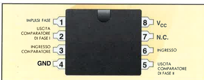
Circuito integrato a otto terminali che rappresenta un comparatore di fase
