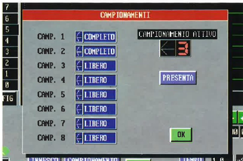
Il pannello dei campionamenti fornisce lo stato di questi ultimi e indica quale è attivo in ogni istante
