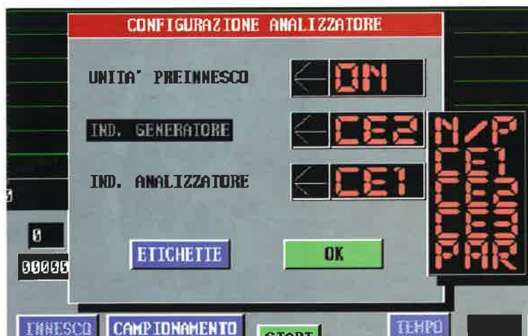
Il pannello di configurazione consente di selezionare la presenza del modulo di innesco e gli indirizzi di attivazione del generatore TTL e dell'analizzatore logico
