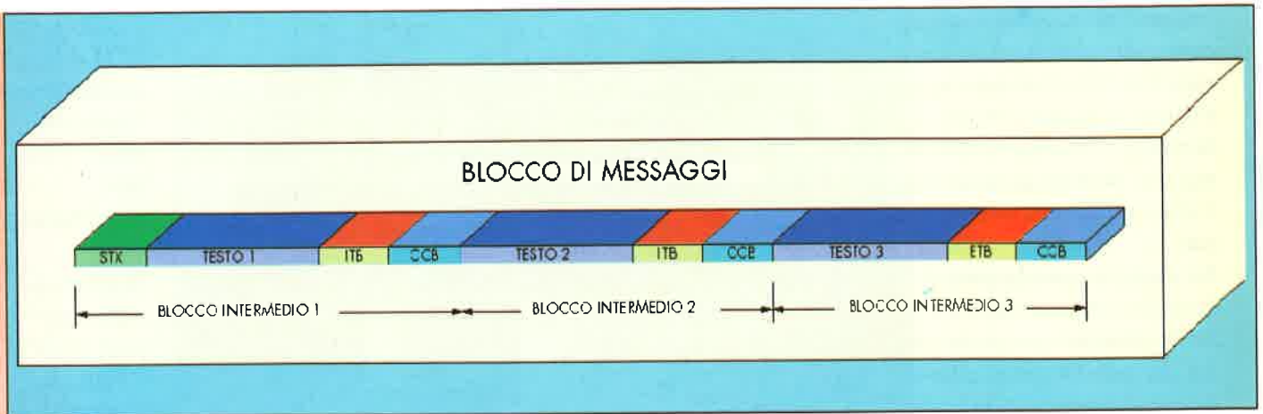
Struttura di un blocco di messaggio diviso in diversi (3) blocchi intermedi in formato non trasparente
