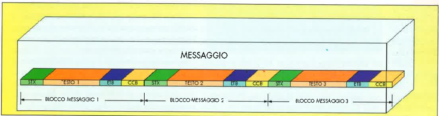
Struttura di un messaggio composto da tre blocchi di messaggio in formato non trasparente
