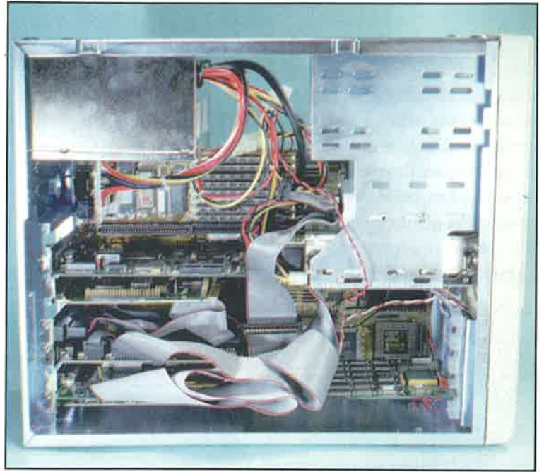
L'unità centrale è fondamentalmente costituita da un alimentatore, un disk drive e una scheda madre
