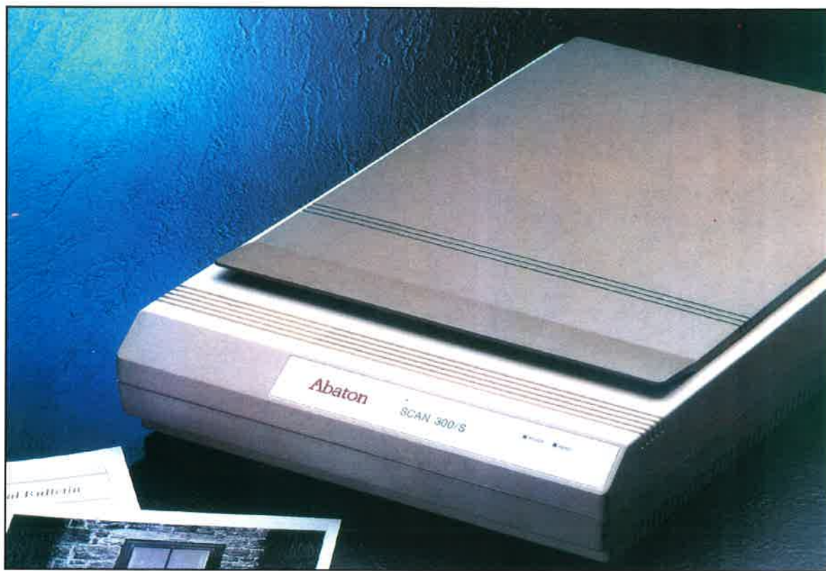
Scanner da tavolo Abaton 300/S, dotato di 16 livelli di grigio
