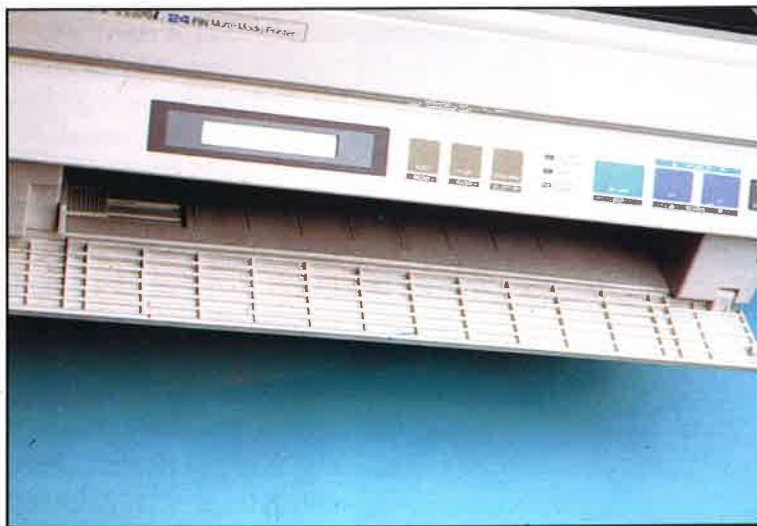
L'alimentatore per fogli singoli ha il compito di fornire alla stampante i fogli necessari
