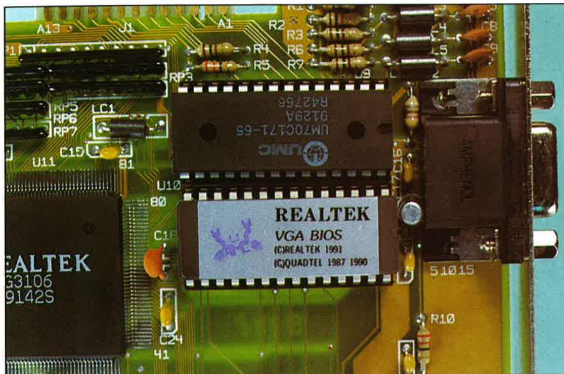
I circuiti integrati RTVGA BIOS e VIDEORAMDAC sono sempre molto vicini tra di loro, e rappresentano il sistema di gestione delle procedure di I/O
