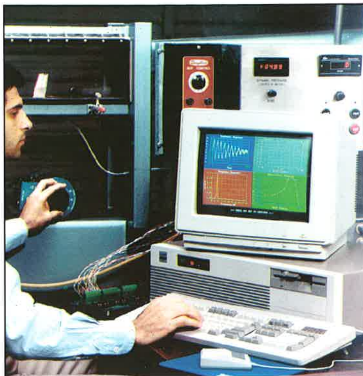
Configurazioni diverse del controller GPIB, con il quale è possibile gestire tutte le apparecchiature ad esso collegate
