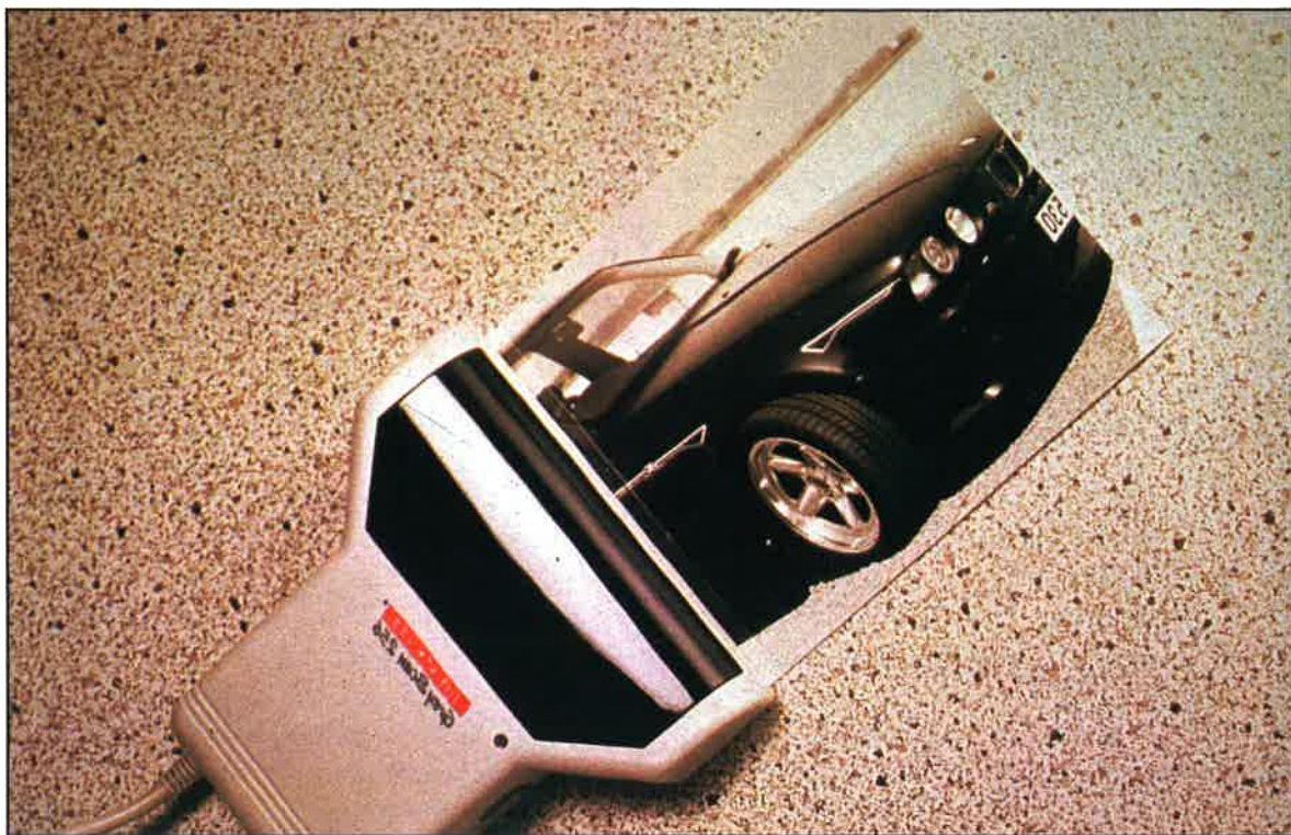
Gli scanner manuali sono in grado di digitalizzare immagini con dimensioni che corrispondono esattamente a quelle di una piccola fotografia
