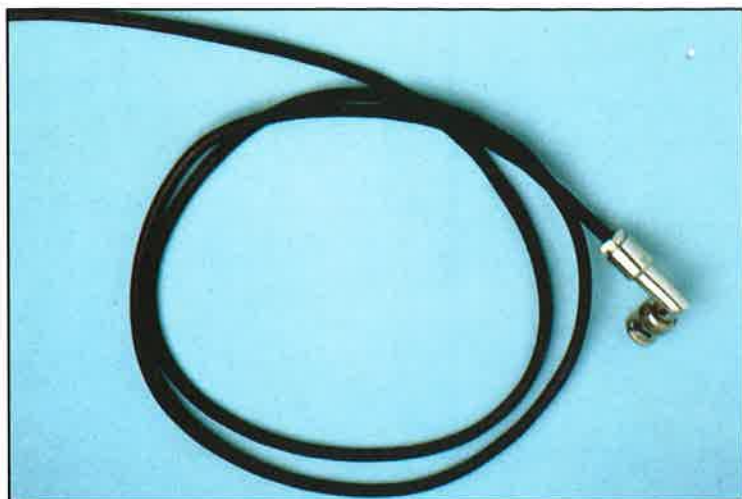
Il cavo coassiale è molto utilizzato nelle reti Ethernet
