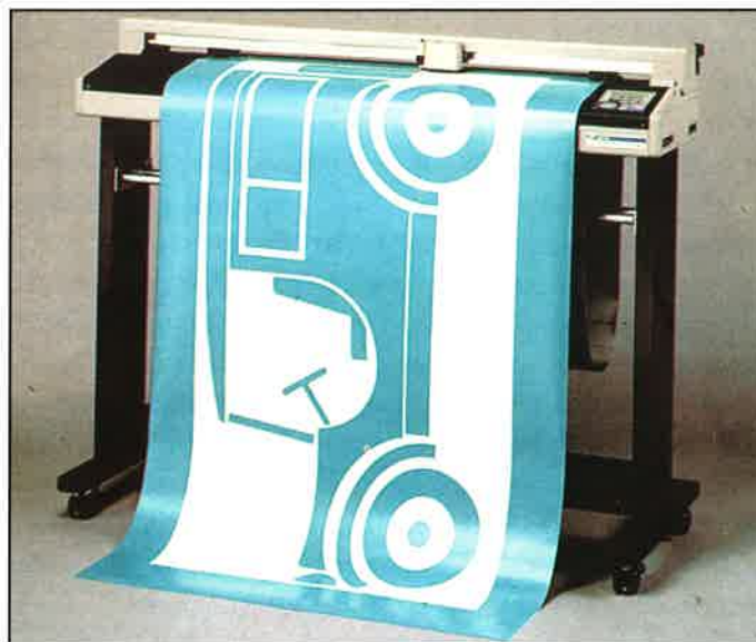
Plotter per incisione ad alte prestazioni con controllo digitale dei servomotori
