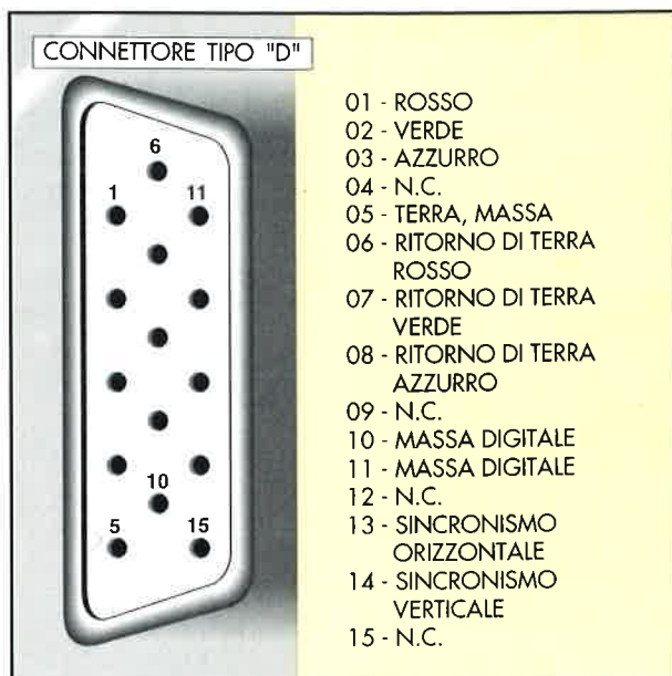
Segnali presenti sul connettore Sub-D della VGA
