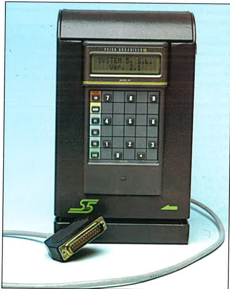
Cavo di collegamento del sistema per il controllo di presenza al computer
