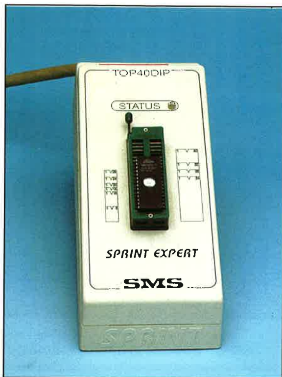
Nell'adattatore esterno al PC viene inserito il componente che deve essere programmato
