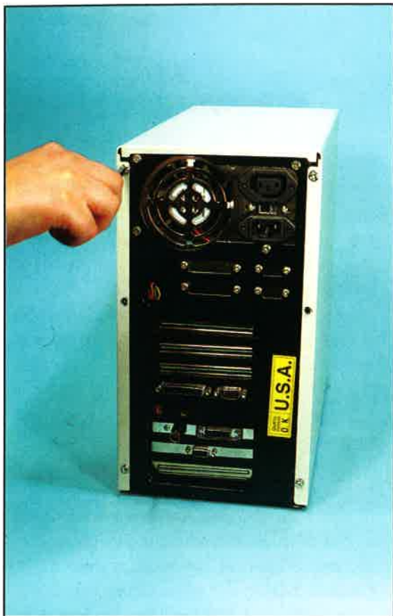
Il cacciavite a stella è lo strumento più adatto per smontare il coperchio esterno del PC
