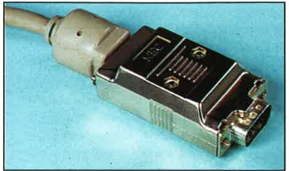
Un monitor VGA viene collegato al controller video tramite un connettore DB-15
