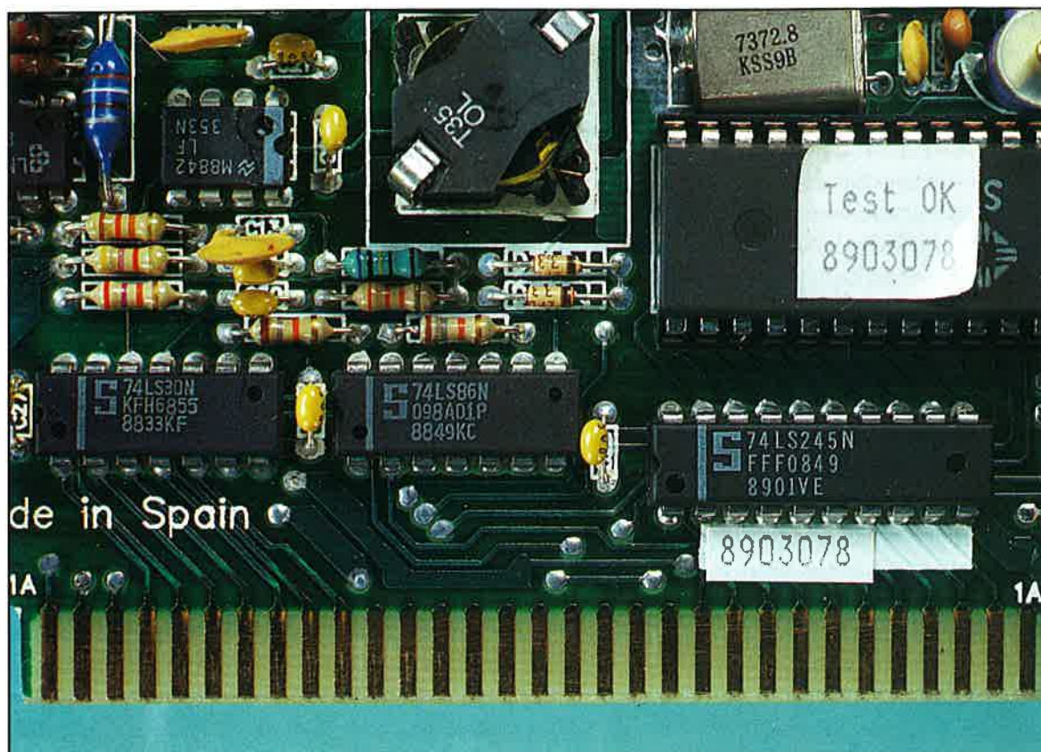
Il modem interno si collega al PC tramite il connettore a pettine presente sul circuito stampato
