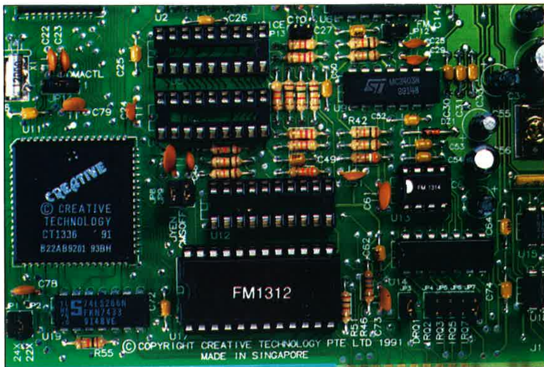
Configurazione di default dei ponticelli presenti sulla scheda
