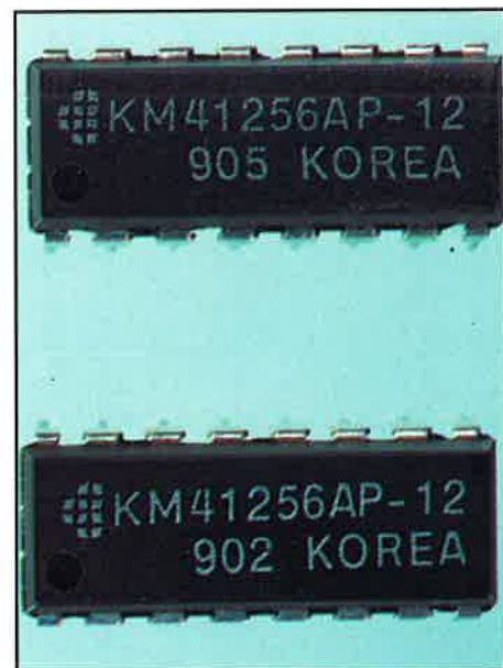
Circuiti integrati 41256P-12, con capacità di 256 Kbit e tempo di accesso di 120 ns
