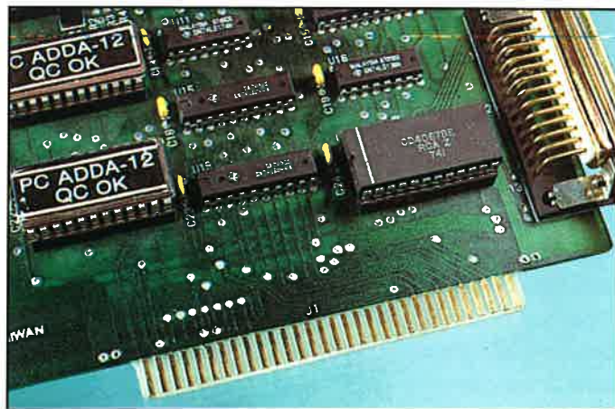
Le schede dei primi compatibili XT erano a 8 bit
