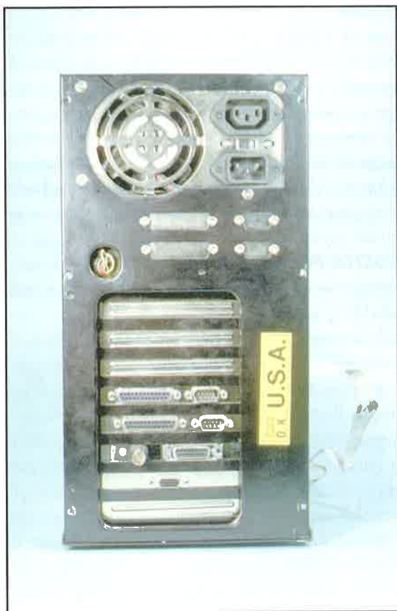
Sulla parte posteriore del PC sono presenti gli slot di espansione e i distinti connettori
