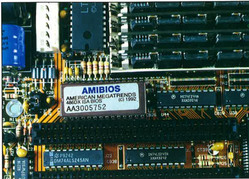
La memoria EPROM contiene il programma di gestione dell'I/O, costituito in questo caso dall'AMI-BIOS
