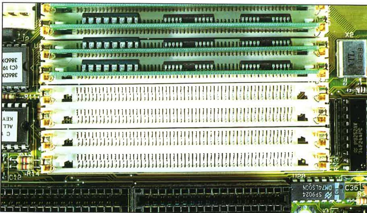
Banchi di memoria RAM della scheda 386, implementati tramite elementi di memoria conosciuti con il nome di SIMM
