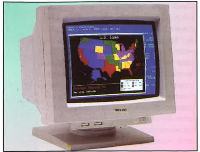
Lo standard SVGA con risoluzione 1024x768 e dimensione del pixel di 0,28 mm è uno strumento indispensabile per applicazioni professionali
