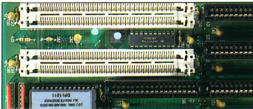
La tecnica di montaggio su zoccoli SIMM consente di risparmiare spazio sulla scheda madre
