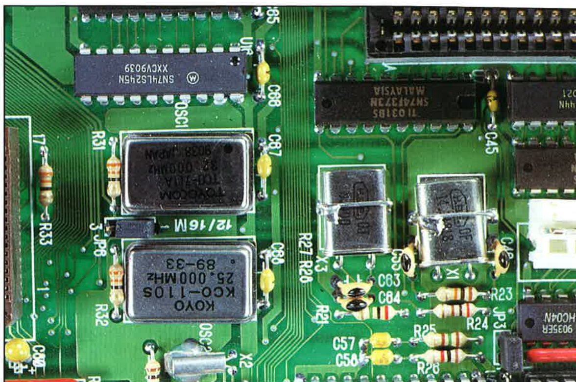
Il quarzo determina la velocità di lavoro del microprocessore
