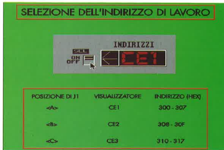
Selezione dell'indirizzo di lavoro. Si osservino le possibili opzioni in funzione della posizione di J1
