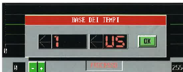
La selezione del tempo di campionamento è possibile solo se il generatore TTL è installato; il tempo e le unità vengono impostate separatamente
