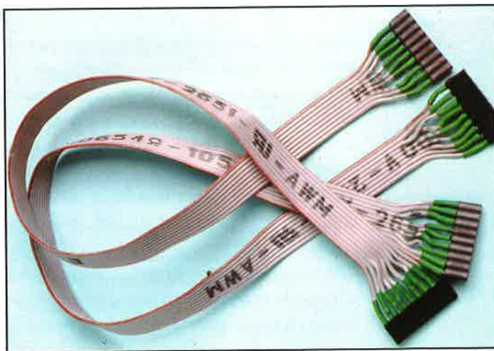
Il collegamento del decodificatore di indirizzi si ottiene per mezzo di un cavo piatto.
