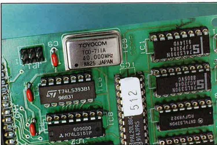
L'ultima operazione è l'inserimento degli integrati nei rispettivi zoccoli. Il loro orientamento è indicato dalla serigrafia presente sullo stampato
