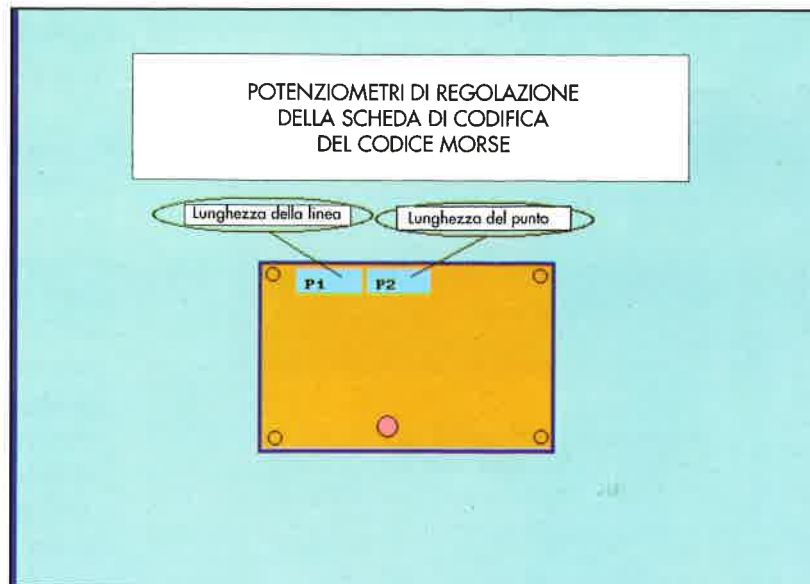
I potenziometri P1 e P2 consentono di regolare la lunghezza della linea e del punto
