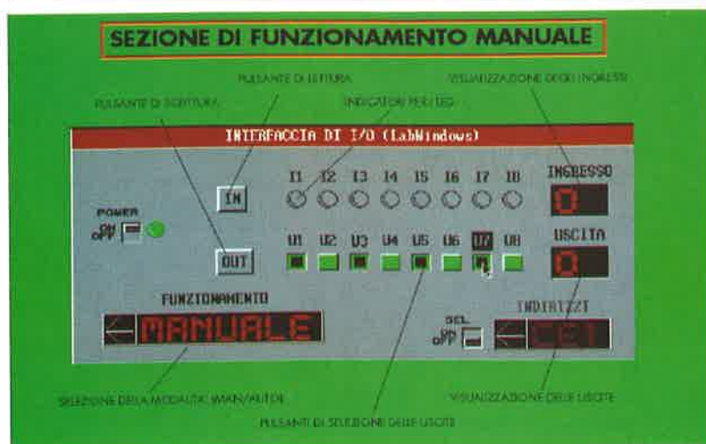
Attuatori della modalità manuale. Si disattivano quando viene selezionata la modalità automatica
