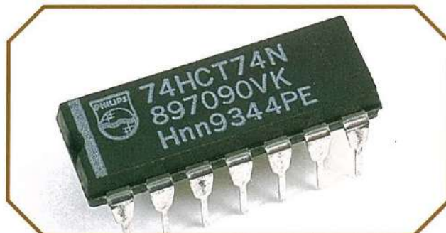
Doppio bistabile tipo D attivato da fronte di salita.
