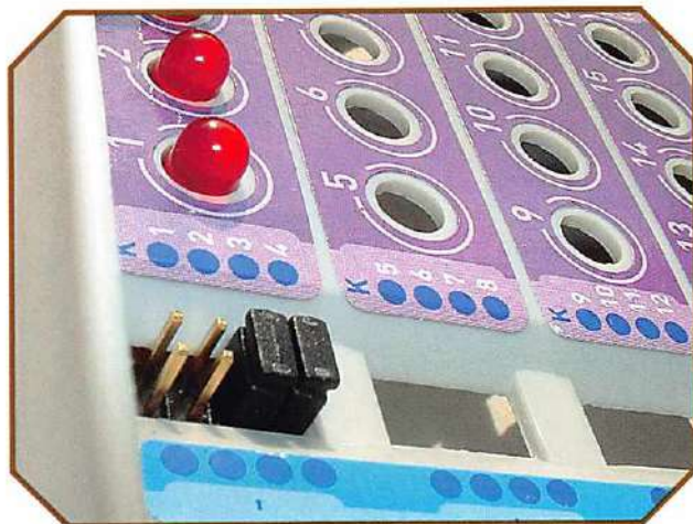
I ponticelli devono essere collocati su K3 e K4 per collegare l'alimentazione ai catodi dei LED.
