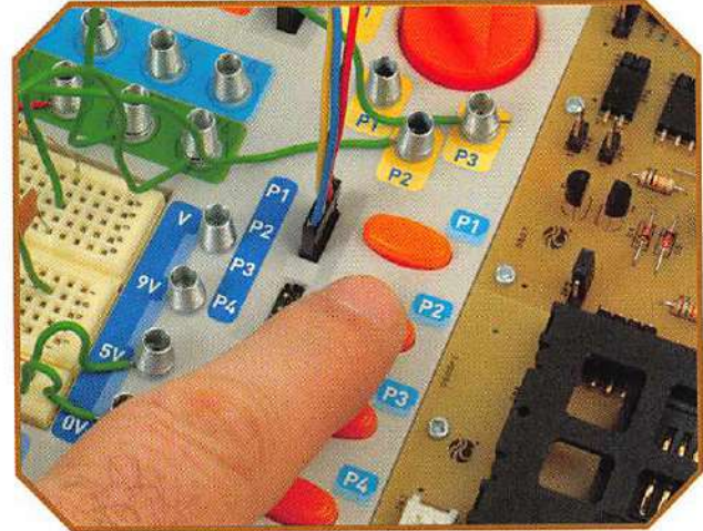
Il pulsante P2 indicato nello schema come TEST, si utilizza per eseguire la misura.
