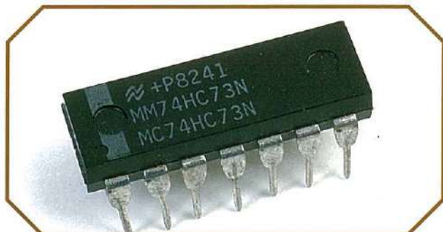
Doppio bistabile tipo J-K attivato da fronte di discesa.
