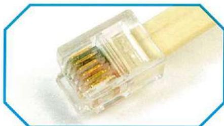
*Dettaglio dell' RJ11, utilizzato in telefonia e collegamenti di modem RTB (Rete Telefonica di Base).*
