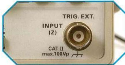
Connettore di ingresso del trigger esterno.
