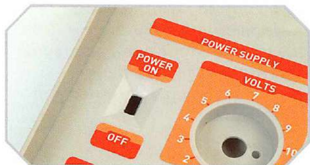
In questa zona verrà montato il commutatore.
