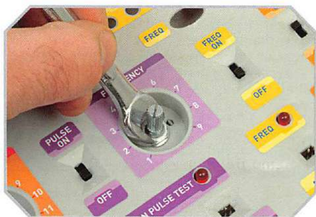
Prima di chiudere il bullone verificate la centratura.
