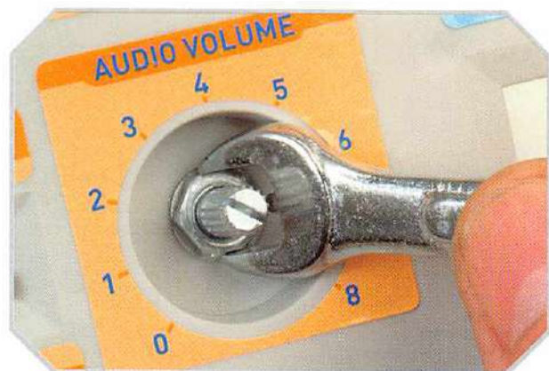
La vite si può chiudere con una comune chiave inglese.
