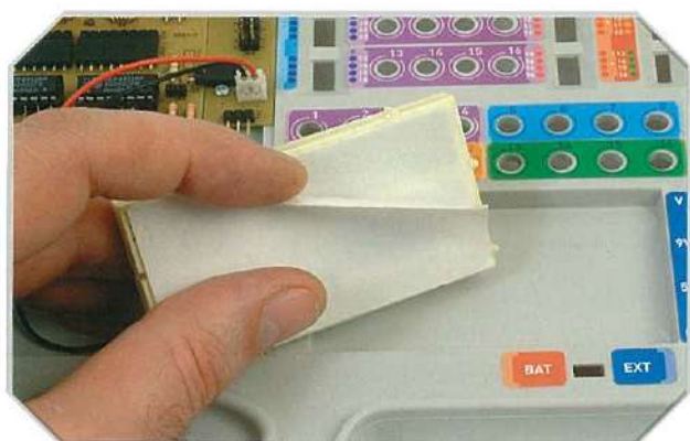
Il modulo ha un nastro adesivo con una lamina di protezione.
