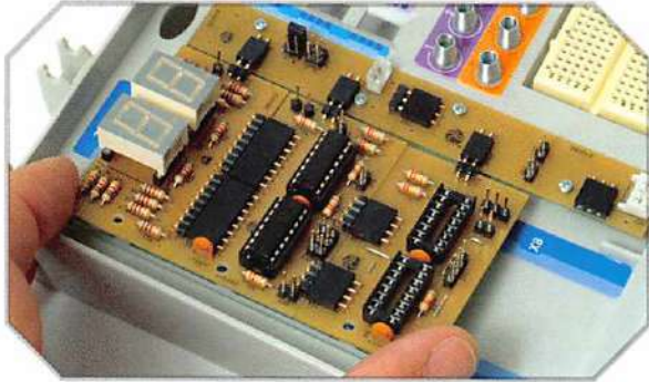
L'insieme formato da DG01, DG02 e DG03 viene inserito sulle schede DG04 e DG05.
