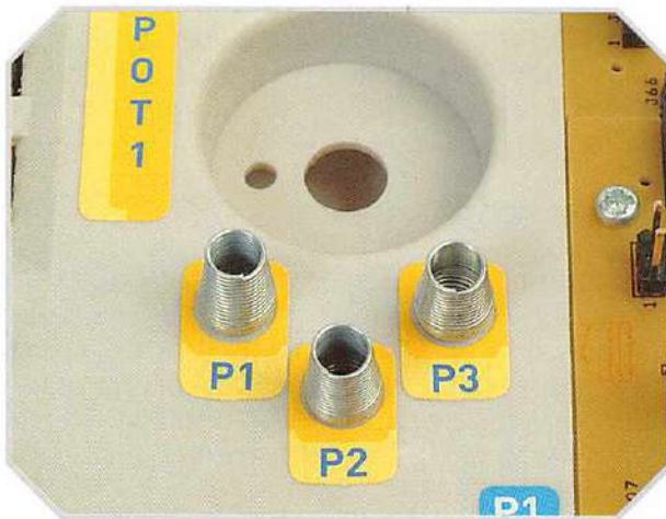
Molle di collegamento inserite.
