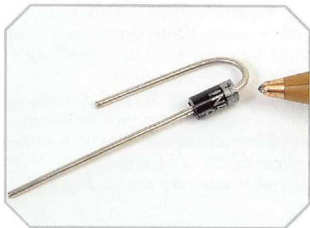
Il terminale del catodo si deve piegare così.
