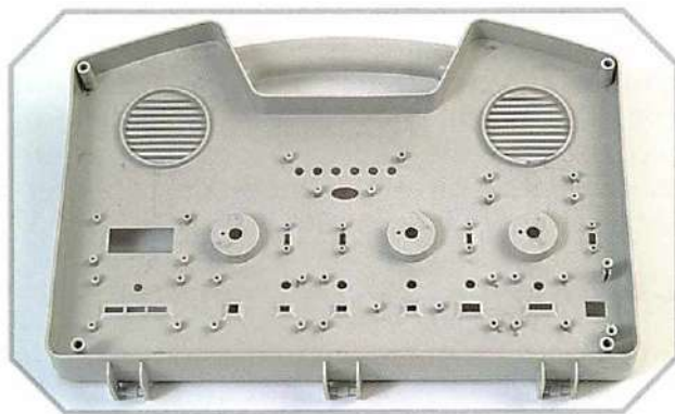
Interno del pannello superiore.
