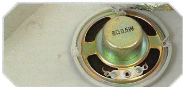
Fissaggio mediante calore.
