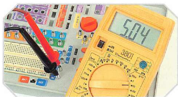
Dobbiamo misurare 5 V con il commutatore in EXT.
