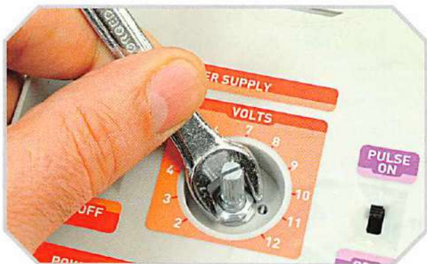
Montaggio del potenziometro.
