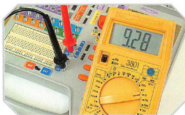
Sulla posizione BAT si alimenta solo tramite batterie.
