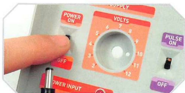
Spostando su ON il commutatore POWER arriva l'alimentazione alla scheda DG18.
