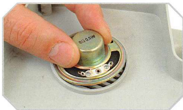
L'altoparlante si deve inserire nel suo alloggiamento.
