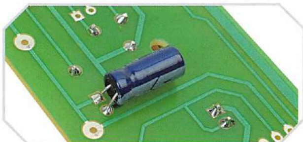
I condensatori elettrolitici si montano sull'altro lato della scheda.
