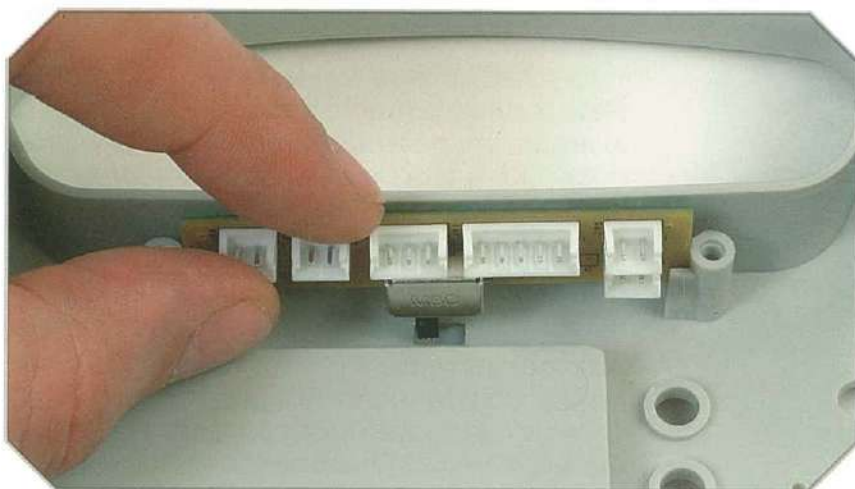
La scheda si inserisce in modo che il comando del commutatore fuoriesca dal foro nel pannello.
