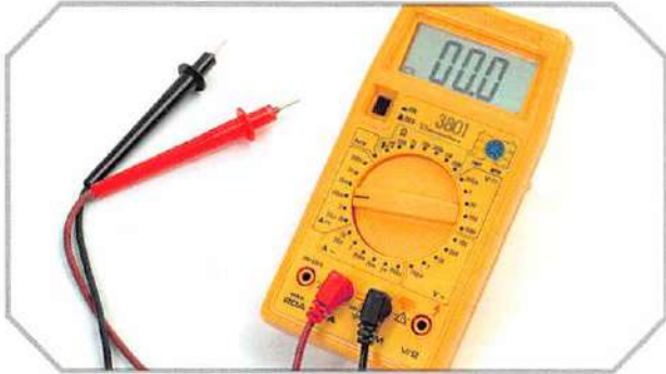
Multimetro disposto per la misura di corrente.
