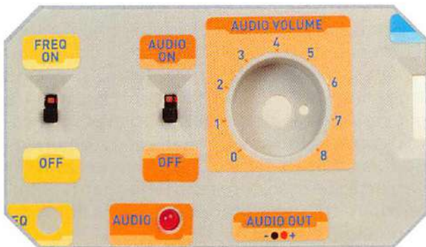
Alloggiamento per il potenziometro del volume.
