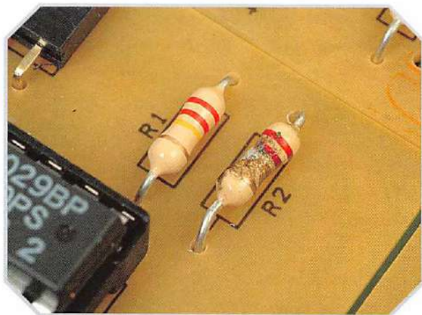
Resistenza che è necessario sostituire.
