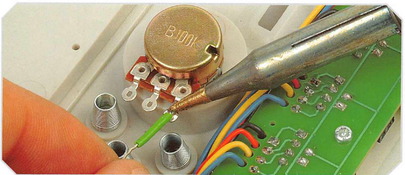
È necessario saldare un filo su ogni terminale.
