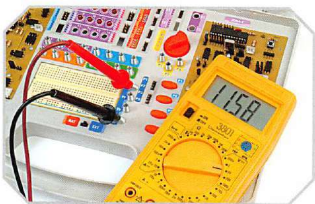
Misura della tensione di uscita.
