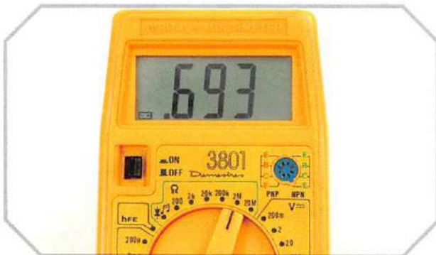
Risultato errato ottenuto da una resistenza da 1 M.
