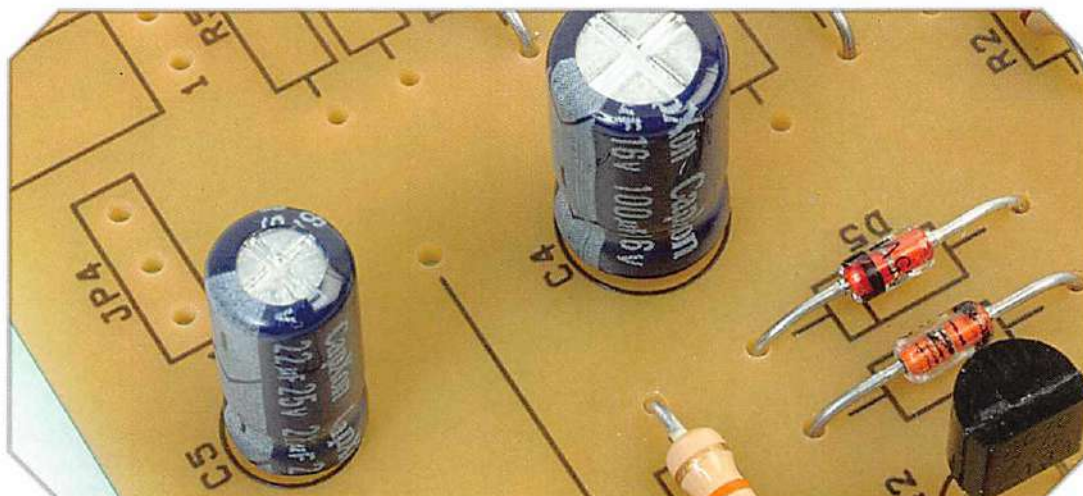
Il condensatore C5 è elettrolitico, da 22 \mu\text{F} .
