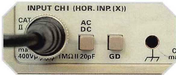
Dettaglio del commutatore AC, DC e del GND.
