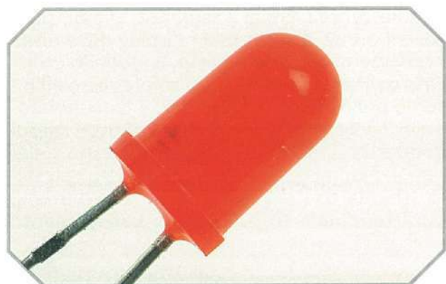
LED da 5 mm di diametro.
