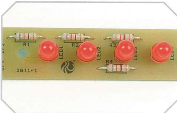
Nella seconda fase si saldano le resistenze.
