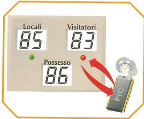
Esempio di interrupt interni nel PIC.
