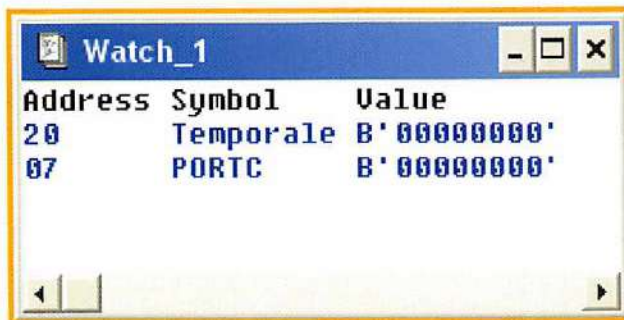
Forziamo il valore del registro TMR2 per rendere più agile la simulazione.
