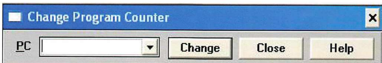
Finestra per modificare il valore del contatore di programma PC.
