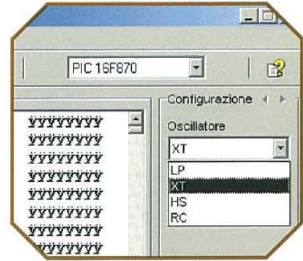
Sul programma Icprog bisogna selezionare il tipo di oscillatore.
