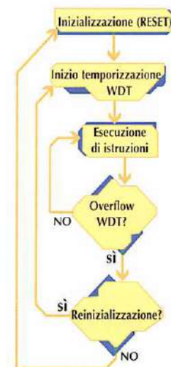
Funzionamento del Watchdog.
