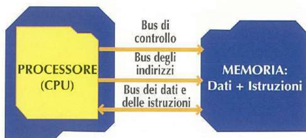
Architettura tipo Von Neumann.
