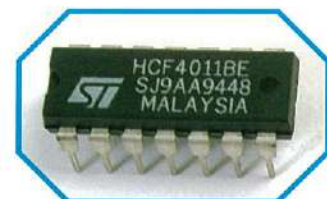
Il 4011 ha al suo interno quattro porte NAND a due ingressi.
