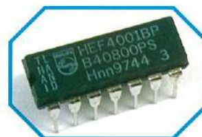
Il circuito integrato 4001 contiene quattro porte NOR a due ingressi.
