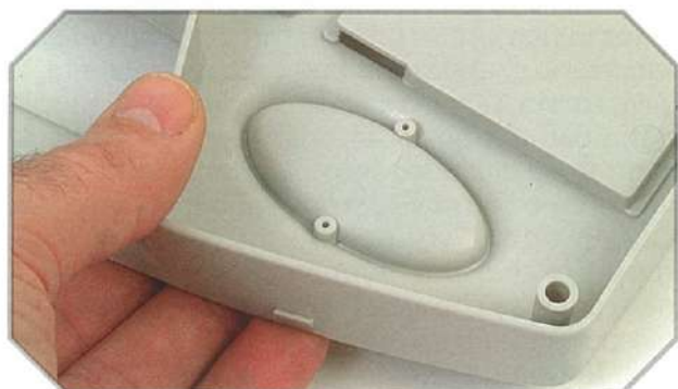
Alloggiamento del portabatterie sotto la zona dei contatori.
