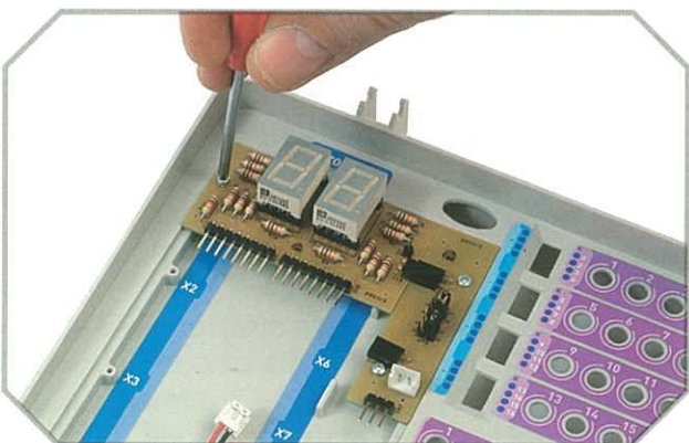
Per la scheda DG01 è sufficiente una sola vite di fissaggio.
