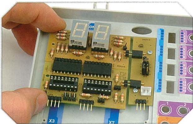
L'insieme DG01-DG02 si collega ai connettori J42 e J43 di DG04.
