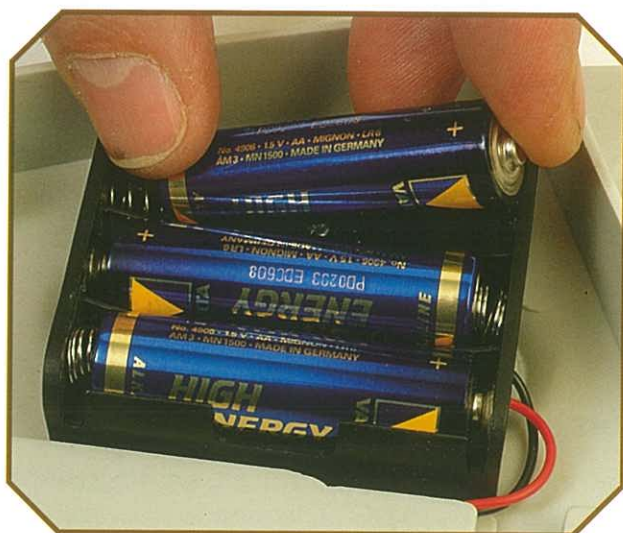
Una delle prime cose da fare è verificare che le pile siano montate esattamente.
