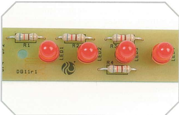
Nella seconda fase si saldano le resistenze.
