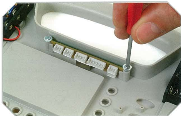
Questa scheda si fissa con due viti a testa allargata.
