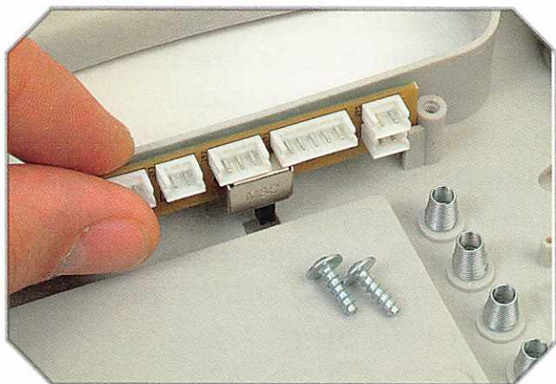
La scheda DG09 si toglie svitando prima le due viti che la fissano.
