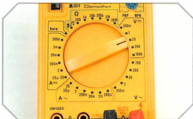
Multimetro impostato per la misura della tensione sulla scala di 20 V DC.
