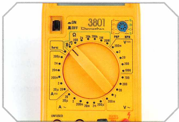
Multimetro impostato per misurare la continuità.
