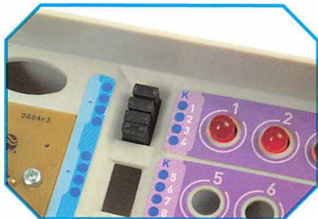
Bisogna montare i ponticelli sui catodi dei LED.
