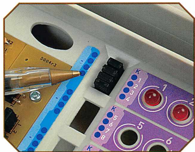
I ponticelli vanno montati sui catodi dei LED utilizzati.
