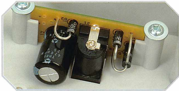
La scheda si fissa con due viti a forma particolare.
