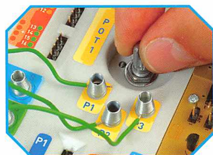
La posizione del potenziometro determina la frequenza di oscillazione.
