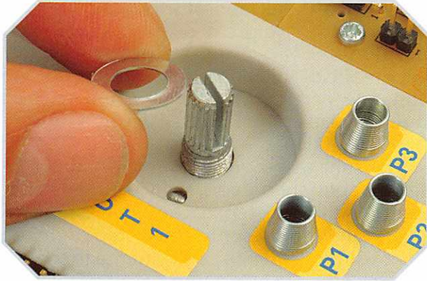
Prima della vite bisogna inserire la rondella.
