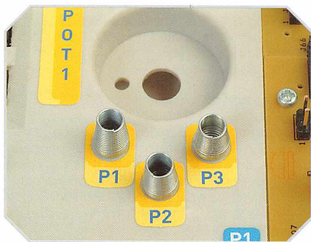
Molle di collegamento inserite.
